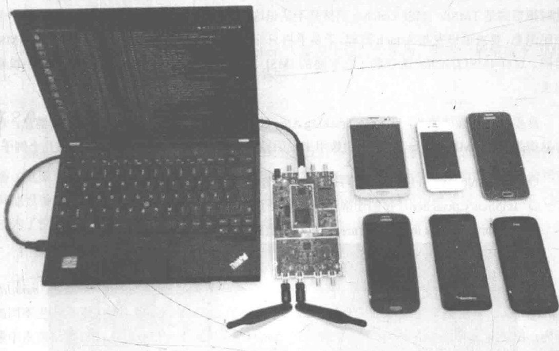
图7-12 利用USRP和开源软件实现的低成本IMSI Catcher
