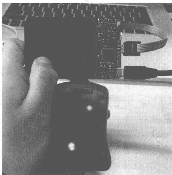
图2-31 Chameleon-Mini连接正常
