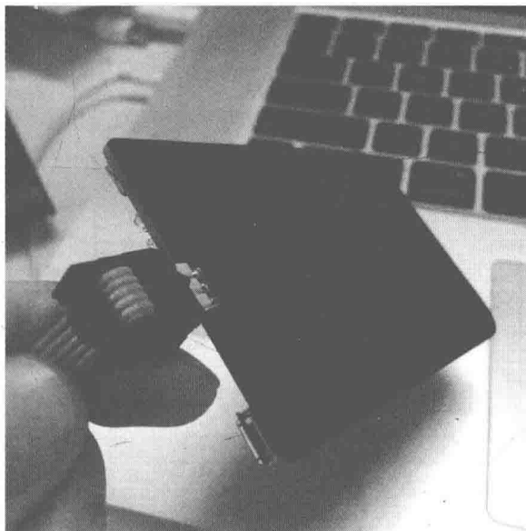
图2-30 Chameleon-Mini烧写端子连接
