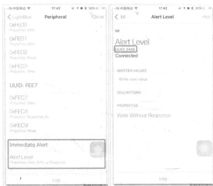
图5-12 使用LightBlue使小米手环振动
