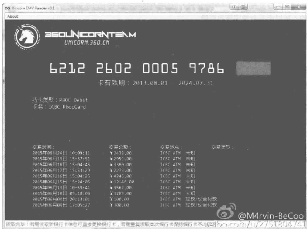
图2-54 Windows客户端读取非接触式银行卡信息
