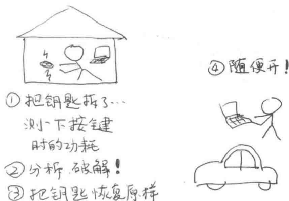
图3-25 KeeLog算法破解
